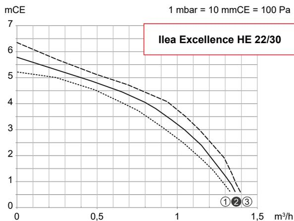
fig. 27 - Verfügbare Drücke und Volumenstromstärken
