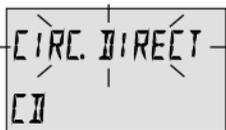
Ce niveau contient les paramètres pour le réglage du mode de fonction réduit du circuit de chauffe direct et pour l'adaptation à chacun des systèmes de chauffe.
