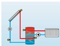
La fonction thermostat fonctionne indépendamment de l'activité solaire et peut s'utiliser, par exemple, pour réaliser le chauffage d'appoint ou pour récupérer l'excès de chaleur.
