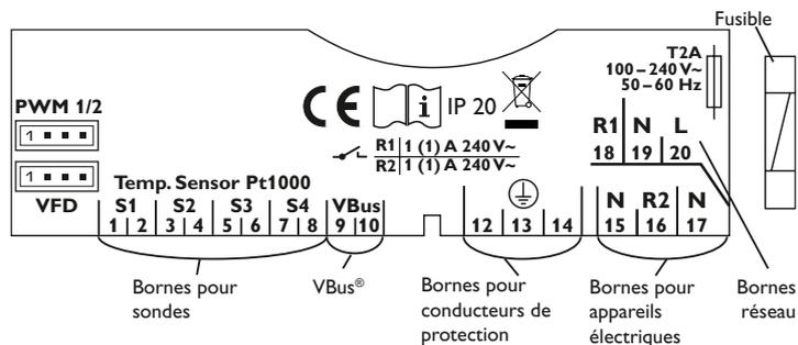
La tension d'alimentation doit être comprise entre 100 – 240 V~ (50 – 60 Hz). Fixez les câbles sur le boîtier à l'aide des serre-fils inclus dans le matériel de montage et des vis correspondantes.
