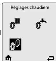
Pour naviguer sur l'écran, pousser sur les touches de déplacement vers le **HAUT**, le **BAS**, la **GAUCHE** et la **DROITE** (🔼🔽🔀🔁) et valider la sélection en appuyant sur la touche **OK**. Pour augmenter/diminuer une valeur, appuyer sur les boutons de déplacement vers le **HAUT/BAS** ou vers la **GAUCHE/DROITE**, en fonction de la situation.
