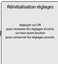
**Réinitialisation réglages** permet à l'installateur de ramener tous les paramètres CH, ECS, et Cascade à leurs valeurs d'usine (aller à [«Valeurs d'usine et de réinitialisation»](#) pour voir les paramètres par défaut).
