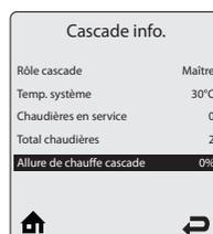
**Allure de chauffe cascade** - Indique l'allure de chauffe actuelle de l'installation en cascade complète.
