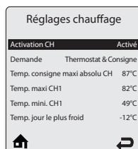
Le menu **Réglages chauffage** contient les paramètres liés au fonctionnement du chauffage central. Chaque ligne contient un paramètre CH suivi de sa valeur actuelle. Six paramètres sont affichés simultanément à l'écran.
