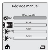
**CH1** - Appuyer sur le bouton **OK** lorsque l'icône CH1 est sélectionnée, afin d'allumer manuellement le(s) circulateur(s) CH1 comme ce serait le cas pour une demande CH.
