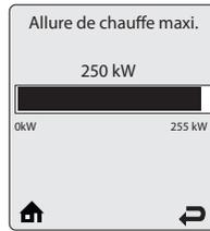
L'allure de chauffe maxi correspond à la capacité maximale d'une seule chaudière dans l'installation en cascade.
