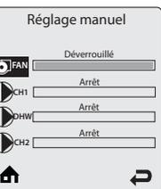
**FAN** - Appuyer sur le bouton **OK** lorsque l'icône FAN est sélectionnée, afin d'allumer manuellement le brûleur et mettre en marche le circulateur CH1.
