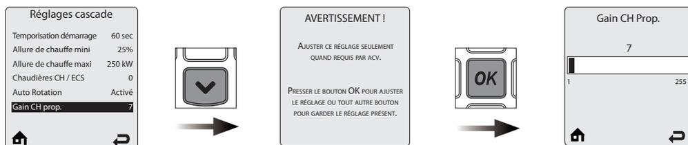
**Gain CH Prop.** permet d'adapter la réaction de la cascade à une demande chauffage central. La fonction Gain CH Prop. a d'autant plus d'effet que la température de l'installation est éloignée de la consigne.
