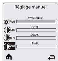
**CH2** - Appuyer sur le bouton **OK** lorsque l'icône CH2 est sélectionnée, afin d'allumer manuellement le(s) circulateur(s) CH2 comme ce serait le cas pour une demande CH.
