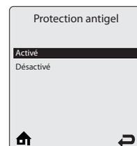
La fonction **Protection antigel** peut être activée et désactivée à cette page. Le mécanisme de protection antigel intégré fait démarrer les pompes de l'installation dès que la température du circuit de départ [sonde NTC1] descend sous 7°C. Quand la température du circuit de départ atteint 5°C, le brûleur s'allume et fonctionne jusqu'à ce que la température du circuit de départ dépasse 15°C. Les pompes continuent à fonctionner pendant 10 minutes environ.
