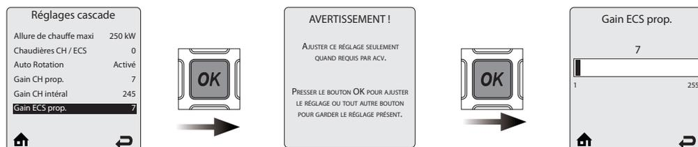
**Gain ECS proportionnel** permet d'adapter la réaction de la cascade à une demande d'eau chaude sanitaire. La fonction Gain ECS proportionnel a d'autant plus d'influence que la température de l'installation est éloignée de la valeur de consigne.
