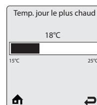
**Temp. jour le plus chaud** constitue la température extérieure la plus haute prévue pour l'installation de chauffage lorsqu'une fonction Régul. ext. est sélectionnée dans l'écran Demande CH. Ce paramètre n'est pas applicable lorsqu'une option Consigne est choisie dans l'écran Demande CH.
