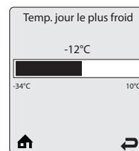
**Temp. jour le plus froid** constitue la température extérieure la plus basse prévue pour l'installation de chauffage lorsqu'une fonction Régul. ext. est sélectionnée à la page Type de demande. Ce paramètre n'est pas applicable lorsqu'une option Consigne est choisie à la page Type de demande.
