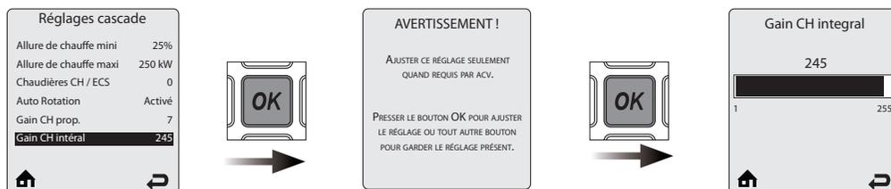
**Gain CH Intégral** permet d'adapter la réaction de la cascade à une demande chauffage central. La fonction Gain CH Intégral a d'autant plus d'influence que la température de l'installation est proche de la valeur de consigne. Appuyer sur les boutons de déplacement vers la **GAUCHE** ou la **DROITE** pour régler le Gain CH Intégral, puis appuyer sur **OK** pour sauvegarder le réglage.
