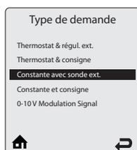
**Constante avec sonde ext.** - Les circulateurs du chauffage central seront activés en permanence en l'absence d'une demande provenant d'un contact sans potentiel. La température de consigne variera en fonction de la température extérieure pour les demandes chauffage central.
