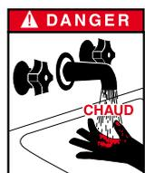
L'eau chaude peut atteindre des températures supérieures à 60°C. Ceci peut provoquer des risques de brûlures. Par conséquent, il est conseillé d'installer un mitigeur thermostatique directement après l'appareil.
