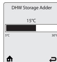
**DHW Storage Adder** - Добавочная температура хранения ГВС - этот параметр используется для вычисления температурной уставки теплоносителя, когда опция Sensor выбрана в меню Demand Type. Температурная уставка теплоносителя при запросе на нагрев системы ГВС будет равна значению DHW Storage Setpoint + DHW Storage Adder.
