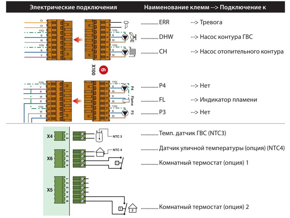
Высокотемпературный и низкотемпературный отопительные контуры с комнатным термостатом на отопительном контуре 1, с возможностью установки в качестве опции второго комнатного термостата и датчика уличной температуры.
