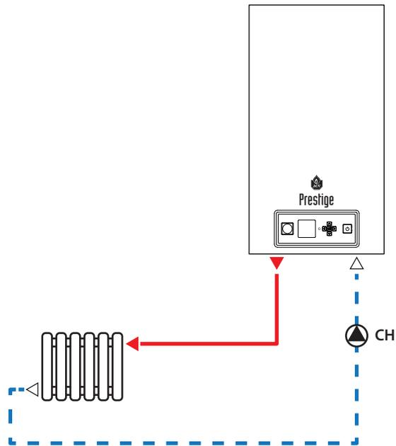
Высокотемпературный отопительный контур, с циркуляционным насосом на обратной линии и контуром ГВС. Также возможна схема с опционально поставляемыми датчиком уличной температуры и комнатным термостатом.
