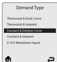
**Constant & Outd. Curve** - Общая температурная уставка - Котел Prestige будет поддерживать значение температурной уставки, игнорируя сигналы от термостата или температурного датчика. Нагрев Сист.Отопл. будет прекращен при достижении значения температуры наружного воздуха, установленного в меню Warm Weather Shutdown Temperature. Значение температурной уставки будет меняться в соответствии с изменением значения уличной температуры.
