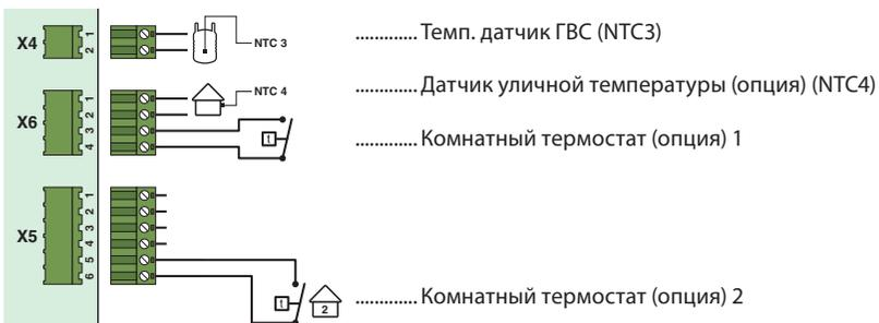
Высокотемпературный отопительный контур с дополнительным насосом нагрузки и контуром ГВС. Также возможна схема с опционально поставляемым датчиком уличной температуры и комнатным термостатом.
