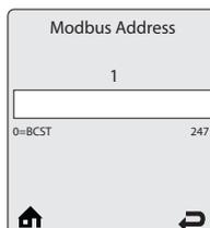
Этот параметр задает адрес котла в системе связи на основе Modbus.
