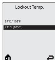
Эта настройка котла позволяет тестировать функцию **Overheat Thermostat** - Предохранительный термостат - при пониженной температуре. При выборе значения 39°C котел отключит нагрев, что безопасно продемонстрирует функцию отключения при перегреве.
