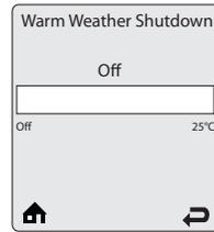
Меню **Warm Weather Shutdown** - позволяет дополнительно установить значение уличной температуры, при которой произойдет отключение системы отопления. При этом котел будет продолжать реагировать на запрос на нагрев системы ГВС или от модулируемого сигнала 0-10V.
