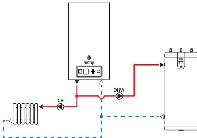
Высокотемпературный отопительный контур с дополнительным загрузочным насосом и контуром ГВС. Также возможна схема с опционально поставляемыми датчиком уличной температуры и комнатным термостатом.
