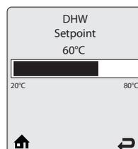
Меню **DHW Setpoint** - Температурная уставка нагрева ГВС - предлагает ввести фиксированную заданную температуру теплоносителя котла во время получения запроса на нагрев системы ГВС, когда выбрана опция Sensor в меню Demand Type.
