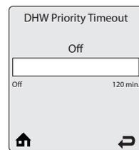
**DHW Priority Timeout** - Время отключения приоритета ГВС - позволяет ввести дополнительное время, в течение которого будет осуществляться приоритет нагрева ГВС над системой отопления, когда установлен параметр Enabled в меню DHW Priority.
