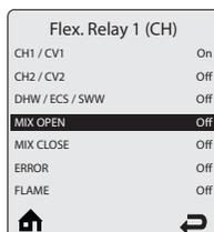
В параметре **Mix Open** активируется функция открытия смесительного клапана. При наличии в гидравлической схеме смесительного клапана, время его открытия устанавливается равной в 120 сек.
