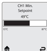
**CH1 Minimum Setpoint** - Минимальная темп. уставка отопительного контура 1 - в этом меню устанавливается минимальное значение температурной уставки, которое может быть выбрано при настройке Кривой уличной температуры (Outdoor Curve) в меню выбора источника запроса на нагрев (Demand Type). Эта настройка не применяется, если в меню Demand Type будет выбрана опция Setpoint.
