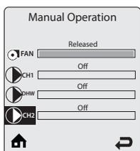
**CH2** - Нажмите кнопку **OK**, когда выделение иконки CH2 будет активно, включатся циркуляционный насос(ы) отопительного контура 2 имитируя действие при получении сигнала запроса на нагрев системы отопления.
