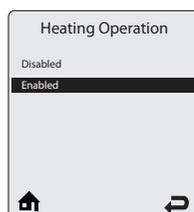
**Меню Heating Operation** Работа системы отопления - позволяет включить или отключить функционирование Сист.Отопл.
