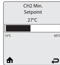
**CH2 Minimum Setpoint** - Минимальная темп. уставка отопительного контура 2 - в этом меню устанавливается минимальное значение температурной уставки, которое может быть выбрано при настройке Кривой уличной температуры (Outdoor Curve) в меню выбора источника запроса на нагрев (Demand Type). Эта настройка не применяется, если в меню Demand Type будет выбрана опция Setpoint.
