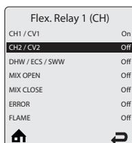
При выборе **CH2**, реле активируется при запросе на нагрев отопительного контура 2.
