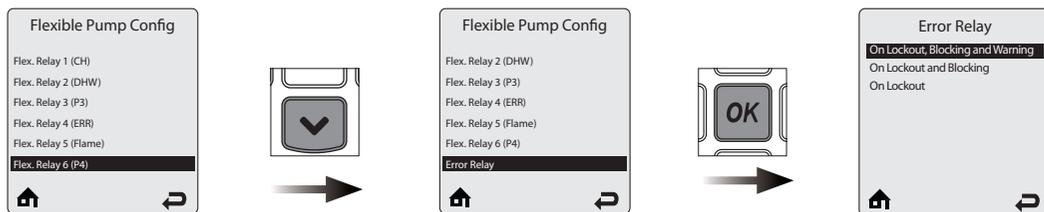
Для Error Relay (Выход Тревога) можно выбрать один из трех возможных вариантов срабатывания:
