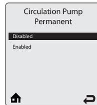
**Circulation Pump Permanent** - позволяет принудительно включить циркуляционные насосы системы отопления в режим постоянной работы, вне зависимости от сигналов запроса на нагрев. Если задействован Приоритет нагрева ГВС, то при получении запроса на нагрев ГВС циркуляционные насосы системы отопления будут отключены.
