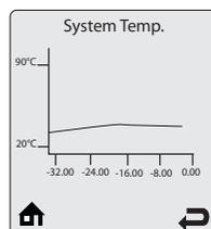
**System Temperature** - Температура Системы - Показывает текущее значение температуры теплоносителя на Ведущем котле. Если температурный датчик не подключен к Ведущему котлу, то отображается температура на подаче теплоносителя в систему.
