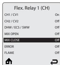
В параметре **Mix Open** активируется функция открытия смесительного клапана. При наличии в гидравлической схеме смесительного клапана, время его закрытия устанавливается равной в 120 сек.
