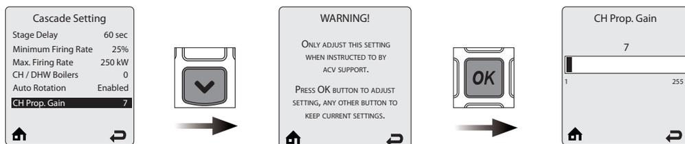
**CH Proportional Gain** - Пропорциональное усиление нагрева - позволяет скорректировать работу Каскадной системы при запросе на нагрев Сист.Отопл. Параметр CH Proportional Gain имеет наибольшее влияние, когда температура теплоносителя значительно ниже заданного значения.
