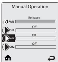
**DHW** - Нажмите кнопку **OK**, когда выделение иконки DHW будет активно, включатся циркуляционный насос(ы) контура ГВС имитируя действие при получении сигнала запроса на нагрев системы ГВС.
