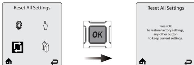
**Reset All Settings** - Сброс всех настроек - позволяет произвести сброс всех настроек Сист.Отопл, ГВС, каскадной системы и вернуться к заводским настройкам по умолчанию. Следуйте инструкциям на экране, чтобы произвести сброс настроек до заводских..
