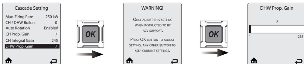
**DHW Proportional Gain** Пропорциональное усиление нагрева - позволяет скорректировать работу Каскадной системы при запросе на нагрев системы ГВС. Параметр DHW Proportional Gain имеет наибольшее влияние, когда температура теплоносителя значительно ниже заданного значения.
