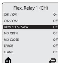
При выборе **DHW**, реле активируется при запросе на нагрев системы ГВС.
