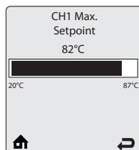
**CH1 Maximum Setpoint** - Максимальная темп. уставка отопительного контура 1 - в этом меню устанавливается максимальное значение температурной уставки, которое может быть выбрано при настройке Кривой уличной температуры (Outdoor Curve) в меню выбора источника запроса на нагрев (Demand Type). Значение CH1 Maximum Setpoint будет зафиксировано для отопительного контура 1, если в меню Demand Type выбрана опция Setpoint.
