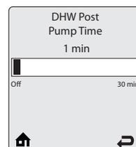
**DHW Post Pump Time** - Время постциркуляции насоса контура ГВС - позволяет установить время, в течении которого циркуляционный насос системы ГВС будет работать после окончания запроса на нагрев. Любые входящие сигналы во время постциркуляции насосов будут игнорироваться котлом, пока не истечет установленное время.
