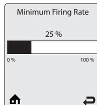
**Minimum Firing Rate** - Минимальная мощность котла - этот параметр позволяет установить процентное значение минимальной мощности одного котла в Каскадной системе. Ведущий котел использует этот параметр, для определения момента включения и отключения Второстепенных котлов.
