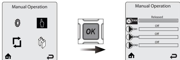
Параметр **FAN** - Вентилятор - Нажмите кнопку **OK**, когда выделение иконки параметра FAN будет активно, включится вентилятор на горелке и циркуляционный насос отопительного контура 1.
