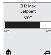
**CH2 Max. Setpoint** - Максимальная темп. уставка отопительного контура 2 - в этом меню устанавливается максимальное значение температурной уставки, которое может быть выбрано при настройке Кривой уличной температуры (Outdoor Curve) в меню выбора источника запроса на нагрев (Demand Type). Значение CH2 Maximum Setpoint будет зафиксировано для отопительного контура 2, если в меню Demand Type выбрана опция Setpoint.
