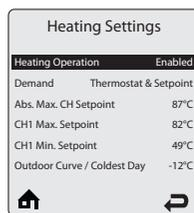
Меню **Heating Settings** - Настройки нагрева системы отопления - содержит параметры, относящиеся к работе системы отопления. Каждая строка отражает наименование настройки и ее текущее значение. Одновременно на дисплее отображается шесть строк.
