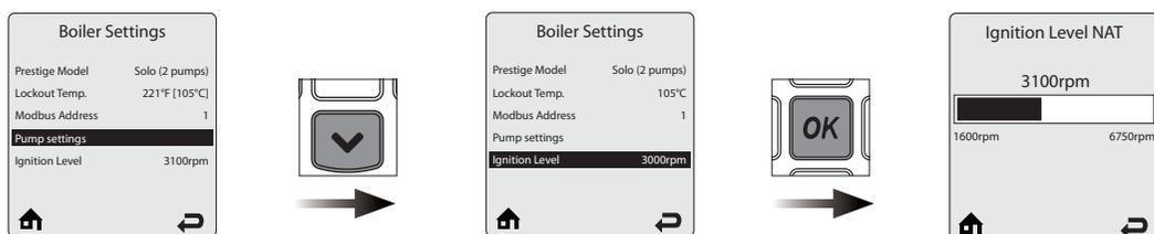
Данный параметр позволяет корректировать обороты воздушного вентилятора во время розжига котла.
