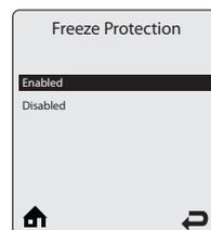
Меню **Frost Protection** позволяет включить или отключить функцию защиты от замерзания. Встроенный механизм защиты от замерзания активируется система насосов, как только температура потока [NTC1 зонд] опускается ниже 7 ° C. Как только температура потока при 5 ° C, горелка включается, пока температура теплоносителя не поднимется выше 15 ° C. Насосы продолжают работать в течение примерно 10 минут.
