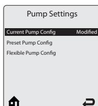
Меню **Pump Settings** - Настройки Насоса - позволяет выбрать правильную конфигурацию насоса в зависимости от выбранной гидравлической схемы. Существует режим предустановленной конфигурации и гибкий режим для настройки.
