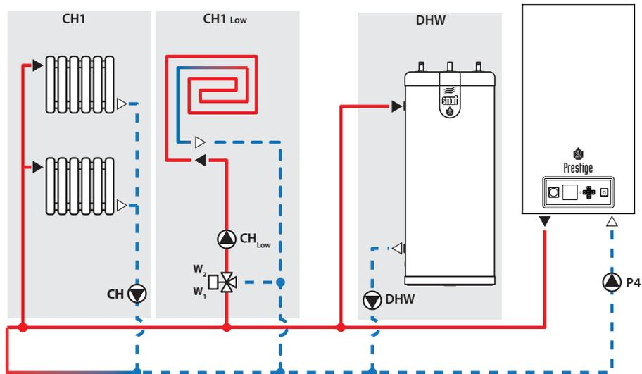
**i** В этой конфигурации мощность насоса ограничена, а два насоса (CH1 и CH1Low) должны быть соединены параллельно. Кроме того, может быть использовано дополнительное реле.
