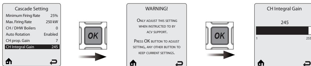
**CH Integral Gain** - позволяет скорректировать работу Каскадной системы при запросе на нагрев Сист.Отопл. CH Integral Gain имеет наибольшее влияние, когда температура теплоносителя близка к заданному значению.
