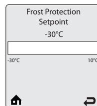
**Freeze Protection Setpoint** - Температурная уставка Защиты от замерзания - позволяет установить температуру наружного воздуха, при которой активируется функция Frost Protection (доступно только при подключенном датчике уличной температуры). Насосы активируются, когда температура наружного воздуха падает ниже значения, установленного в этом параметре.
