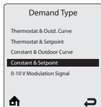
**Constant & Setpoint** - Общая температурная уставка - Котел Prestige будет поддерживать значение температурной уставки, игнорируя сигналы от термостата или температурного датчика. Нагрев Сист.Отопл. будет прекращен при достижении значения температуры наружного воздуха, установленного в меню Warm Weather Shutdown Temperature. Значение температурной уставки будет зафиксировано для запроса на нагрев системы отопления.
