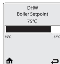
Меню **Boiler DHW Setpoint** - Температурная уставка нагрева ГВС - предлагает ввести фиксированную заданную температуру теплоносителя котла во время получения запроса на нагрев системы ГВС, когда выбрана опция Thermostat в меню Demand Type.
