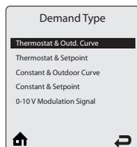
**Thermostat & Outdoor Curve** – Термостат и кривая уличной температуры - Котел Presige получает запрос на нагрев системы отопления от термостата или температурного датчика и данное значение будет меняться для запросов системы отопления, в зависимости от температуры уличного воздуха.
