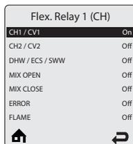
Каждое реле имеет несколько вариантов назначаемых функций. Активация Flexible Pump Config. произойдет, при выборе одного из следующих вариантов: CH1, CH2, DHW, MIX OPEN, MIX CLOSE, ERROR, FLAME.
