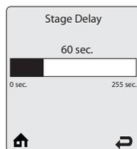
**Stage Delay** Время Задержки - Устанавливает время задержки перед включением или отключением котла в Каскадной системе.
