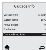
**Cascade Firing Rate** - Мощность каскадной системы - Показывает текущую мощность каскадной системы.
