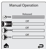
**CH1** - Нажмите кнопку **OK**, когда выделение иконки CH1 будет активно, включится циркуляционный насос(ы) отопительного контура 1 имитируя действие при получении сигнала запроса на нагрев системы отопления.
