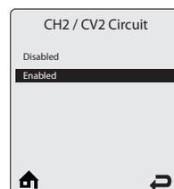
**CH2 Circuit** - позволяет включить или отключить отопительный контур 2.
