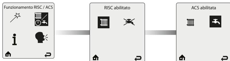
Funzionamento RISC/ACS fornisce un modo semplice per abilitare/disabilitare la funzione di riscaldamento/acqua calda sanitaria della Prestige.
