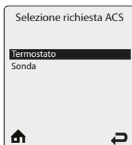
Selezionare **Termostato** quando la sonda bollitore non è installata. Consultare il paragrafo “Guida alla configurazione della caldaia” a pag. 8
