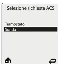
Selezionare **Sonda** quando la sonda bollitore è installata. Consultare il paragrafo “Guida alla configurazione della caldaia” a pag. 8
