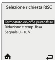
Questo menù è disponibile quando non è installato il sensore di temperatura esterno opzionale. Consultare il paragrafo “Guida alla configurazione della caldaia” a pag. 8
