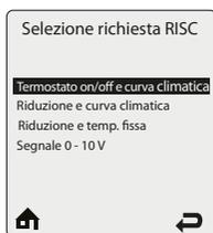
Questo menù è disponibile quando è installato il sensore di temperatura esterno opzionale. Consultare il paragrafo “Guida alla configurazione della caldaia” a pag. 8
