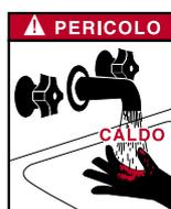
La temperatura di mandata dell'acqua calda potrebbe superare i 60 °C, rischiando di provocare un pericolo di scottature. Si consiglia di prevedere un miscelatore termostatico immediatamente all'uscita della caldaia.
