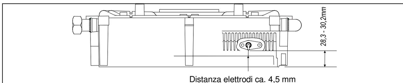
Vista dall'alto del blocco scambiatore con accesso all'elettrodo
