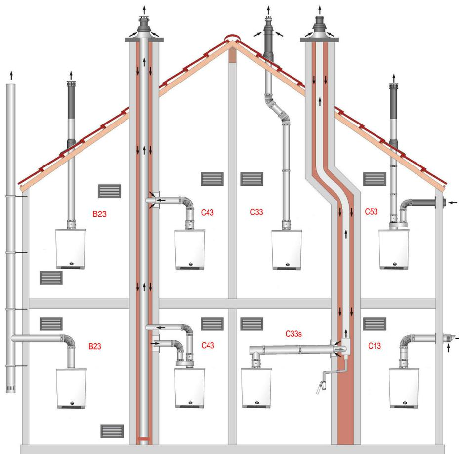
**B23** Collegamento dei prodotti della combustione all'esterno del locale, l'aria comburente è prelevata direttamente all'interno del locale dove è installato l'apparecchio.
