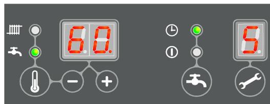
Nel caso in cui sia installato un termostato Open Therm, la temperatura di mandata è determinata dal termostato. Se è installata una sonda esterna, la temperatura di mandata è determinata dalla curva climatica programmata nel regolatore. In questi ultimi due casi, vale come massimo la temperatura di mandata impostata sul pannello di comando.
